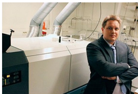
Instrumentet på bilden är en inductively coupled plasma masspektrometer (ICP-MS). Den används för att räkna antalet samt bestämma storleken av individuella nanopartiklar i vätskeprov, bland annat användes den för att mäta halterna av flera partikeltyper i renat avloppsvatten. Foto: Robert Karlsson
