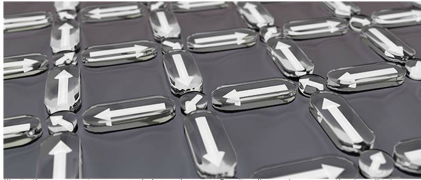
Illustration av provet som används i experimenten. De vita pilarna visar magnetiseringsriktningen för de konstgjorda atomerna. Bild: Erik Östman
